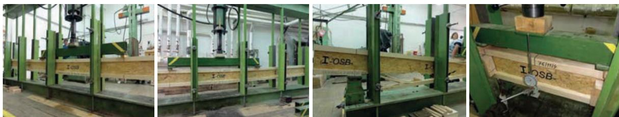
Testování a certifikace dřevěných nosníků I-OSB™
